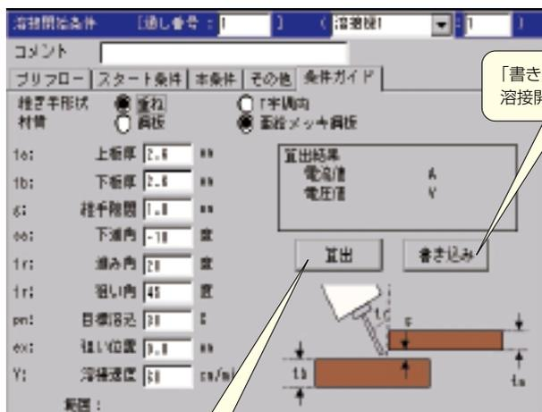
「書き込み」を押すと算出された電流値・電圧値を溶接開始条件ファイルに設定
