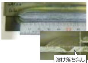
ステンレス 板厚：1 mm 隙間：1 mm 速度：100 cm/min
